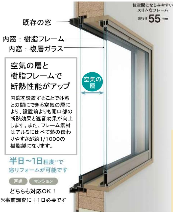
パナソニックの内窓はスリム設計のため、窓額縁内に納まりやすく室内空間になじみます。3つの基本性能「断熱性H-5等級相当」「気密性A-4等級相当」「遮音性T-4等級相当」で開口部の断熱改修に効果的です。
